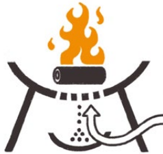
Feuerschale mit Löchern und Aschebecken
